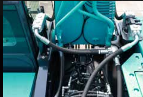
全新破碎锤配管
